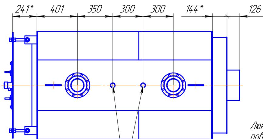
Патрубок предохранительного клапана G1 1/2" (нар.)
